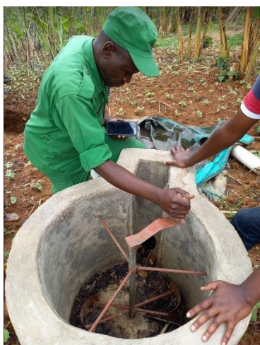
Mélangeur de matière pour la production de biogaz – programme du gouvernement Rwandais entre 2015 et 2017. (Rusasa)
